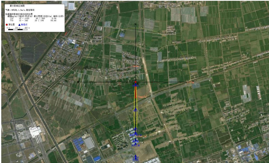
图4.3-4 储罐泄漏氨浓度达到毒性终点时的最大影响范围图
