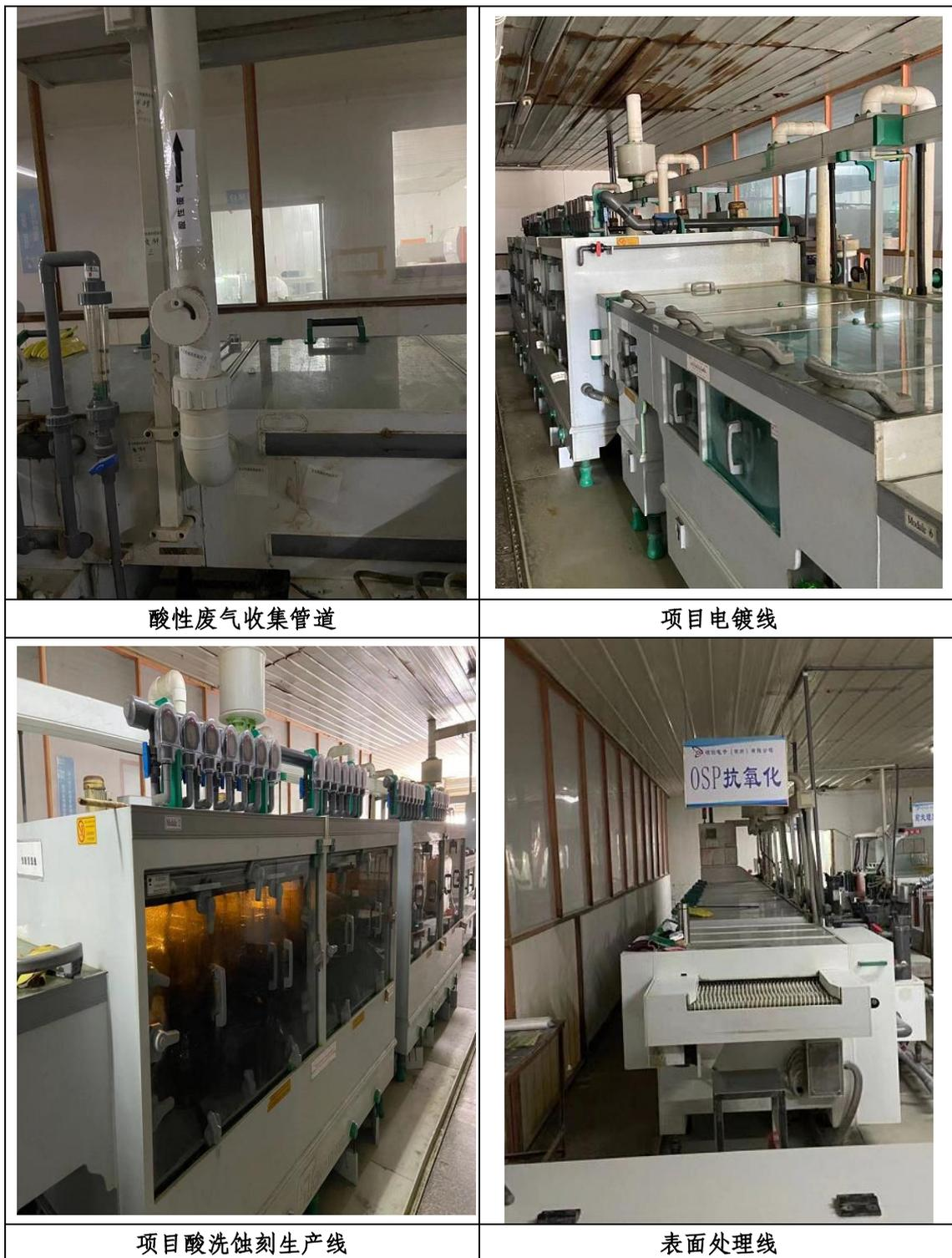
图 6.1-2 同行业线路板生产企业生产设备及废气收集系统示意图
