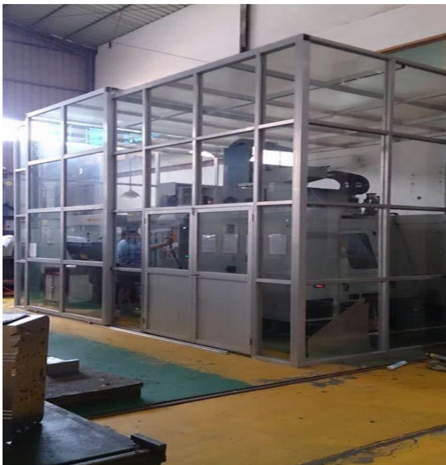
图 6.1-1 涂布机、印刷复合机废气收集示意图
