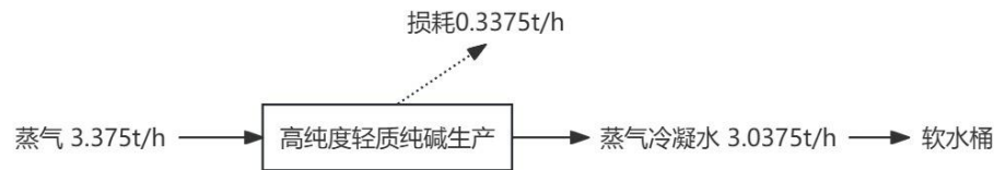
图 2-5 第三分公司高纯度轻质纯碱项目蒸汽平衡图
